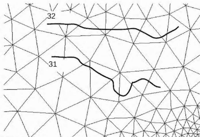
Ces informations doivent être seulement utilisées pour le calage des planchers car **l'interpolation entre deux isocotes ne permet pas de reconstituer l'aléa.**
