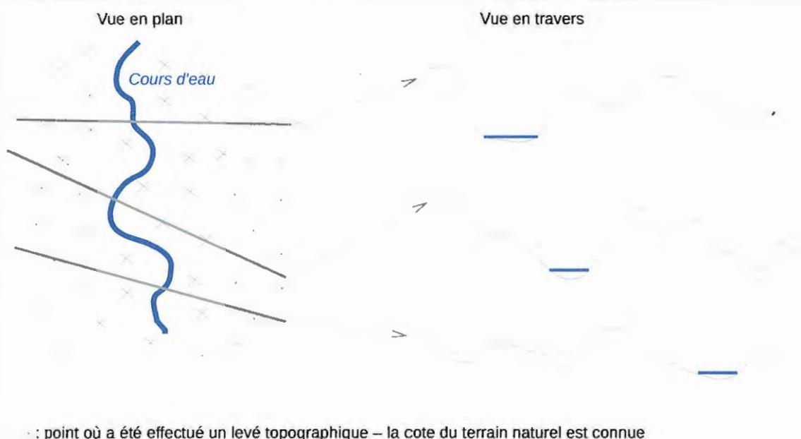
Les profils en travers sont positionnés perpendiculairement au cours d'eau, ne se croisent pas et la connaissance du terrain naturel permet de déterminer leur forme. Ce sont ces profils en travers dans lesquels le modèle hydraulique fera " couler l'eau ".
